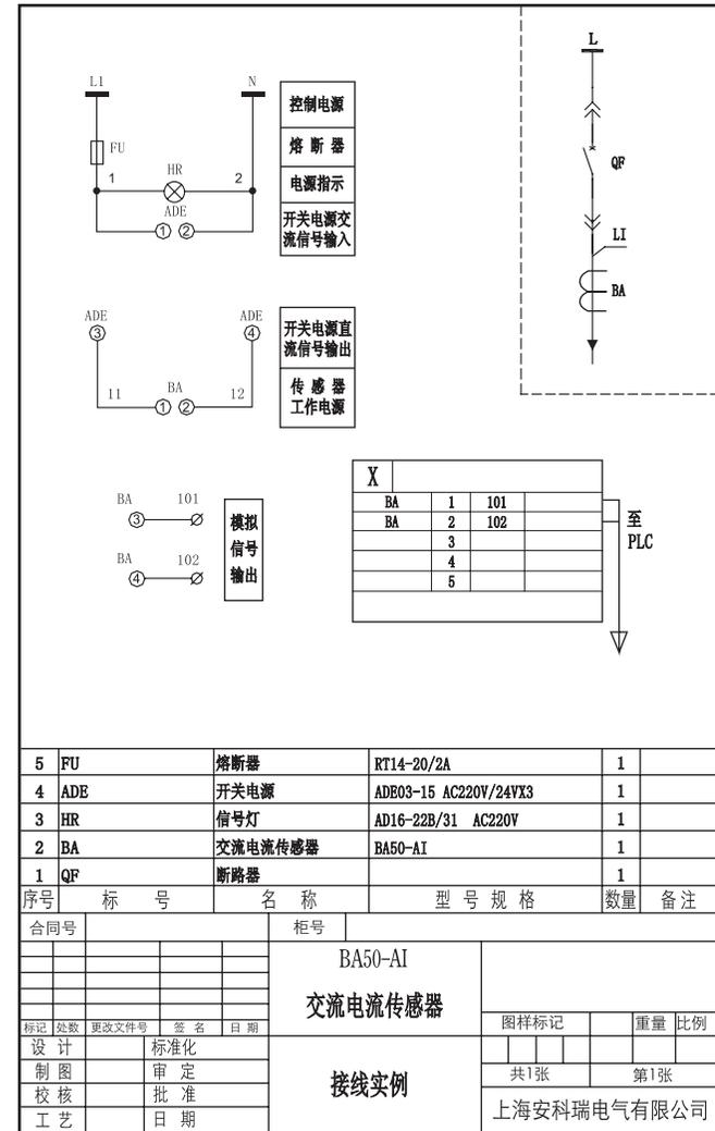
**6 BA50L交流剩余电流传感器 AC residual current sensor**
